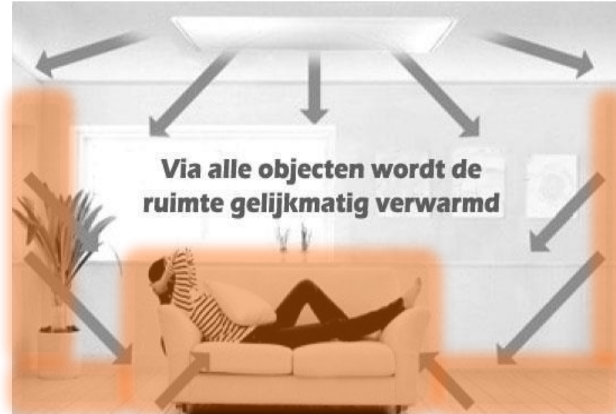
Infrarood verwarming (straling) Energie omgezet in fotonen, Hoge efficiency, Hoog comfort
